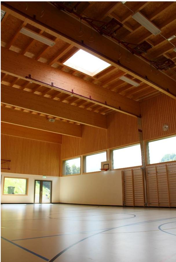
L'ouvrage s'est porté sur un type de construction mixte bois-béton. Les murs en béton sont coulés sur place et assurent la statique du bâtiment. Les ossatures bois sont montées en atelier. Les fenêtres sont en bois-métal avec un verre isolant triple et stores à lamelles.
