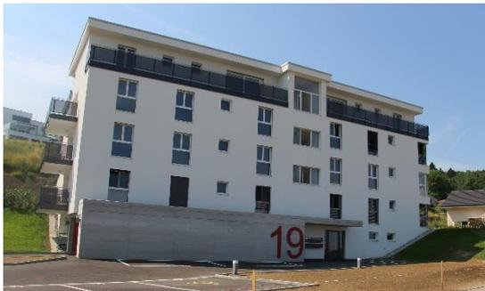
Les barrières de balcon sont réalisées avec un châssis en acier et une main courante en inox, remplissage des contrecœurs avec des tôles perforées.
